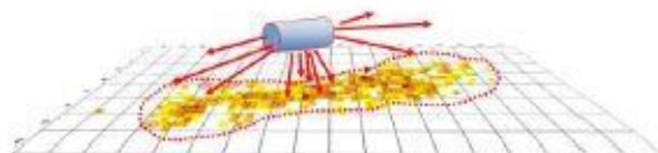
Rys. 35. Układ rozłożenia szczątków wewnętrznej termoizolacji kadłuba z badań archeologicznych. Zawartość kadłuba została „wydmuchnięta” w przeciwnych kierunkach tworząc charakterystyczny kształt pantofla – na obu końcach występuje największe rozproszenie. Rozerwanie wzdłużne skutkuje największym zagęszczeniem pośrodku pola szczątków. Pole szczątków jest odwzorowaniem pola sił [23].
